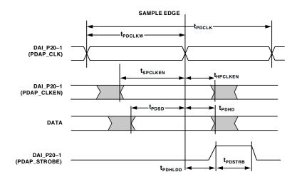
Figure 24. Parallel Data Acquisition Port (PDAP)
